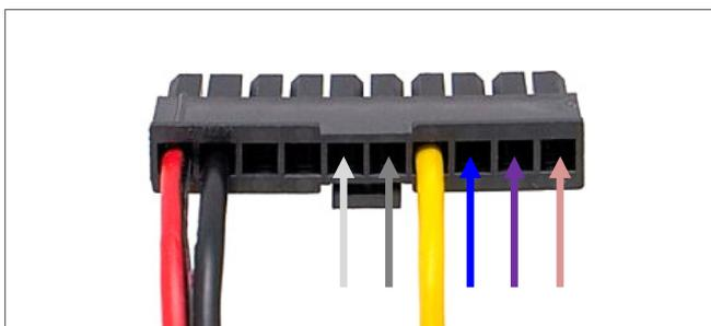
Das Buchsengehäuse des Anschlusskabels wird an den in der Abbildung markierten PIN's mit zusätzlichen Kabeln bestückt. Stecken Sie das ggf. lose gelieferte weiße, graue, blaue, violette oder rosa Crimpkabel in das Gehäuse des Anschlusskabels in die markierte Position PIN 5 bis PIN 10 ein. Die Crimpkabel (Weiß, Grau, Blau, Violett und Rosa) erhalten Sie von Ihrem Fachhändler.
