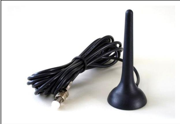
Die Positionierung der GSM-Antenne ist weniger kritisch. Die GSM-Antenne darf ebenfalls nicht von metallischen Gegenständen abgeschirmt werden. Um die Empfangseigenschaften zu verbessern, ist die Antenne senkrecht, also vertikal zu montieren und der Magnetfuß an eine Metallfläche zu heften.
